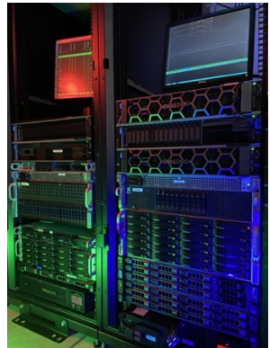
Un cluster de calcul de 12 serveurs avec 35 GPUs.
